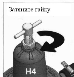
Открутите гайку (рисунок Н2), закрутите винт регулировки давления вниз, чтобы повысить давление (рисунок Н3). По окончании регулировки давления закрутите гайку, чтобы зафиксировать винт регулировки давления в текущем положении (рисунок Н4).
