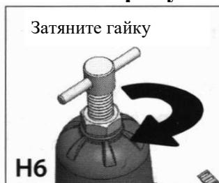
Выкрутите винт регулировки давления вверх, чтобы понизить давление (рисунок Н5). По окончании регулировки давления закрутите гайку, чтобы зафиксировать винт регулировки давления в текущем положении (рисунок Н6).
